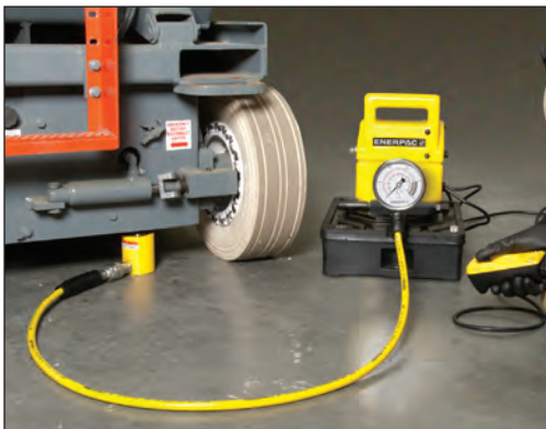
▼ Una bomba económica, la PUJ-1200B se utiliza con un RCS-302 para reposicionar un elevador de tijera y simplificar el mantenimiento.
