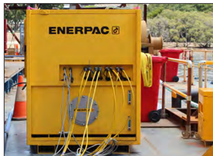
▼ Paquete de energía SyncHoist para operar los 4 puntos de elevación.
