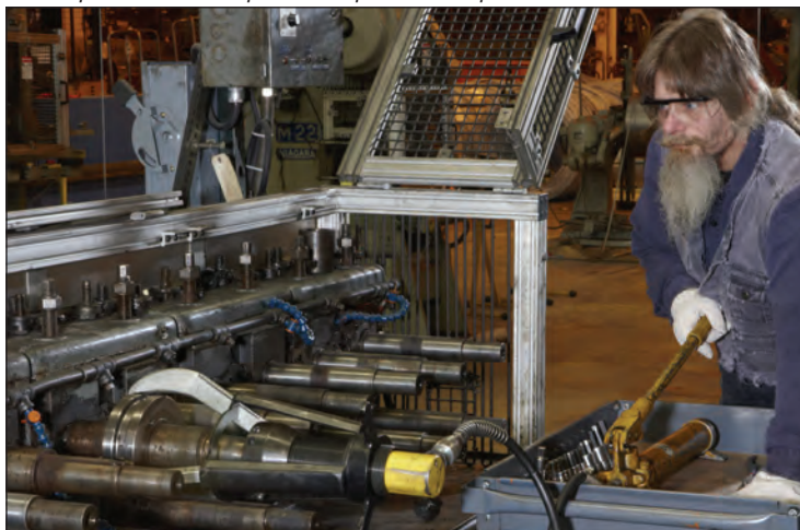
▼ Un extractor Posi Lock® hidráulico EPH-113 retira fácilmente piezas maquinadas de una prensa de producción pesada.
