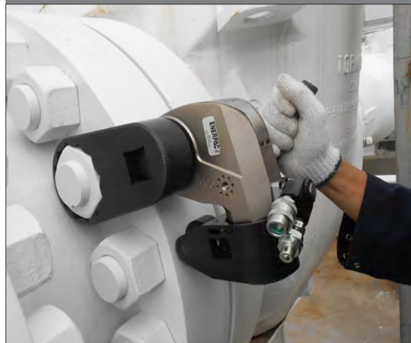
▲ Llave de torque S11000X personalizada con enlace de torque personalizado y rodillo de reacción.
