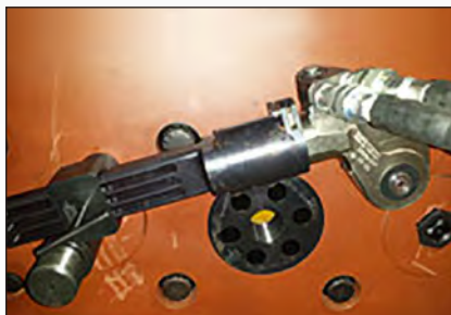
◀ Llave de torque hidráulica personalizada para una bomba para fracturación hidráulica (fracking).
