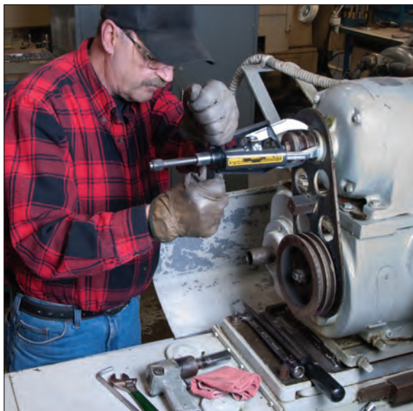
◀ Posicionamiento de un extractor de 3 mandíbulas EP-104 en la polea de accionamiento de un motor eléctrico.
