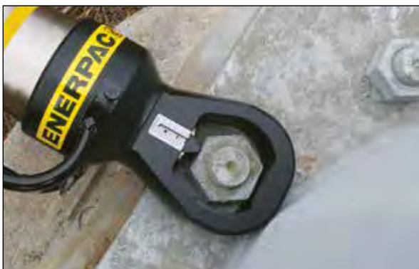
◀ Con el cortatuercas de la serie NS se extraen rápidamente tuercas muy corroídas y desgastadas.
