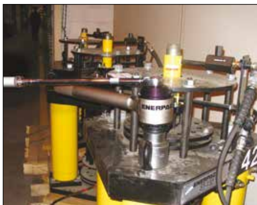
◀ Multiplicador de par con barra de reacción E393 de Enerpac utilizado para apretar a mano pernos con un par de hasta 4300 Nm.
